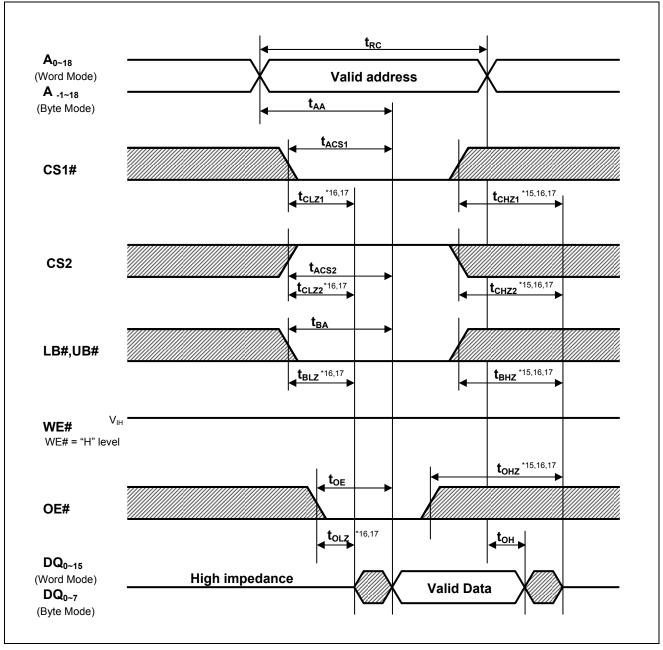
Note 14. BYTE#≥ Vcc -0.2V or BYTE#≤ 0.2V
