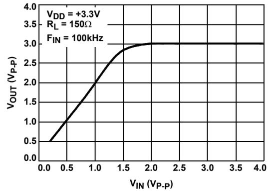
FIGURE 4. MAXIMUM OUTPUT MAGNITUDE vs INPUT MAGNITUDE
