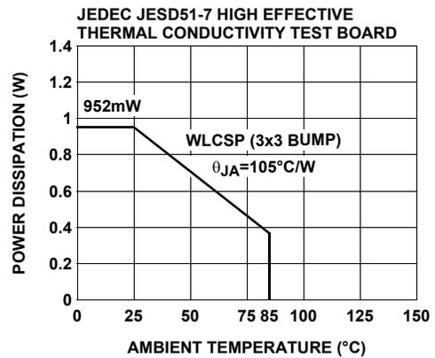
FIGURE 22. PACKAGE POWER DISSIPATION vs AMBIENT TEMPERATURE
