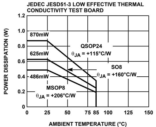
FIGURE 18. PACKAGE POWER DISSIPATION vs AMBIENT TEMPERATURE
