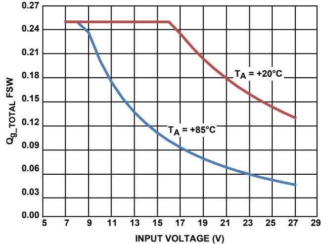
FIGURE 28. ALLOWED MAXIMUM GATE CHARGE vs INPUT VOLTAGE
