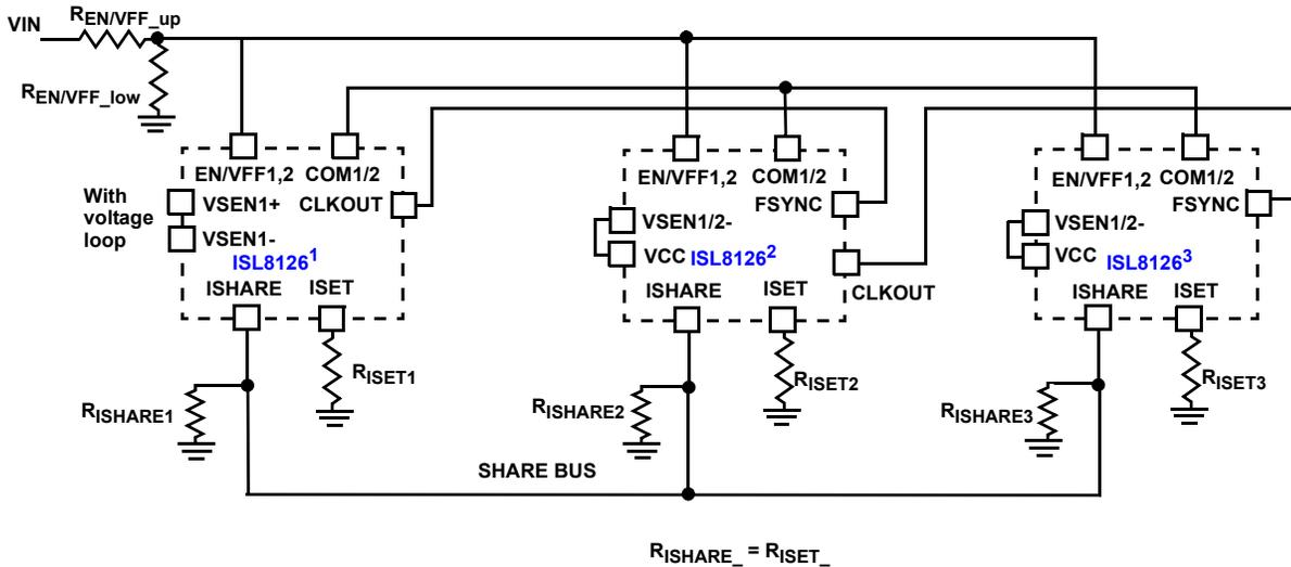
FIGURE 24. SIMPLIFIED 6-PHASE SINGLE OUTPUT IMPLEMENTATION
