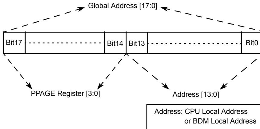
**Figure 47. PAGE Address Mapping**
