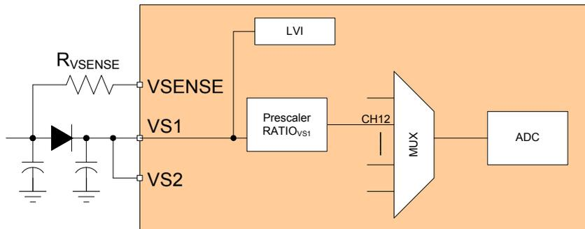
Figure 40. VS1Sense Module
