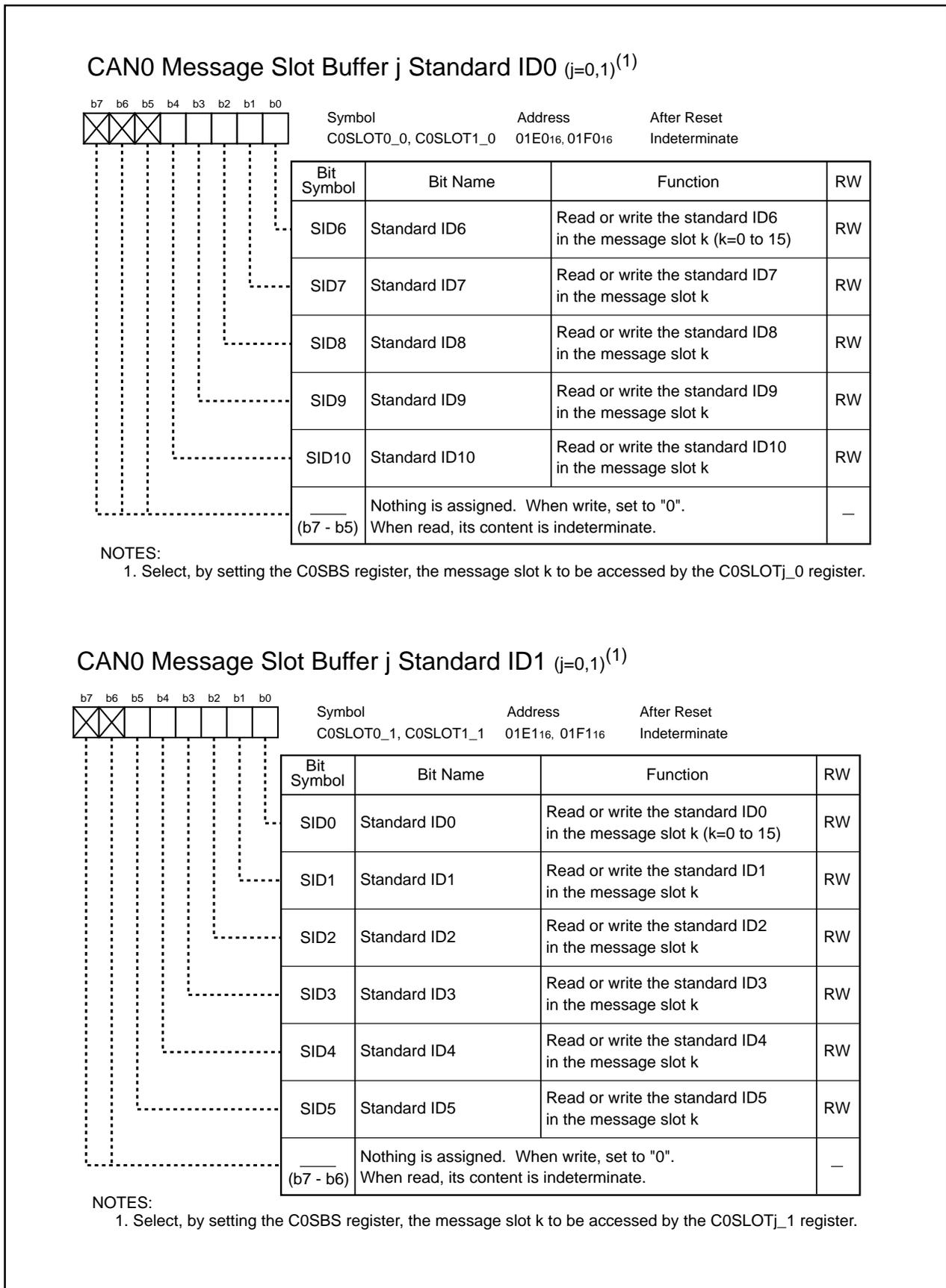
**Figure 23.31 C0SLOT0\_0, C0SLOT1\_0, C0SLOT0\_1 and C0SLOT1\_1 Register**
