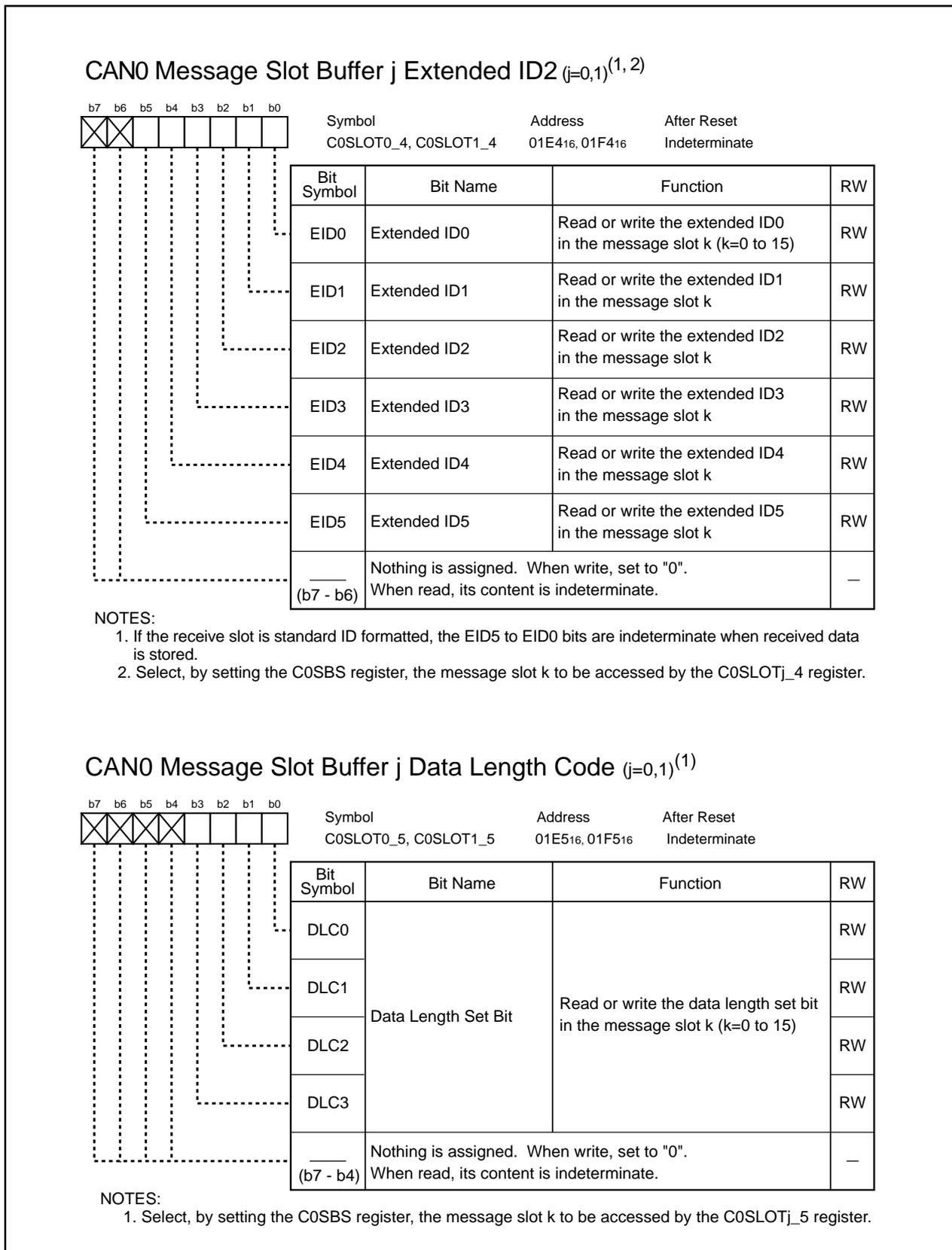
**Figure 23.33 C0SLOT0\_4, C0SLOT1\_4, C0SLOT0\_5 and C0SLOT1\_5 Registers**
