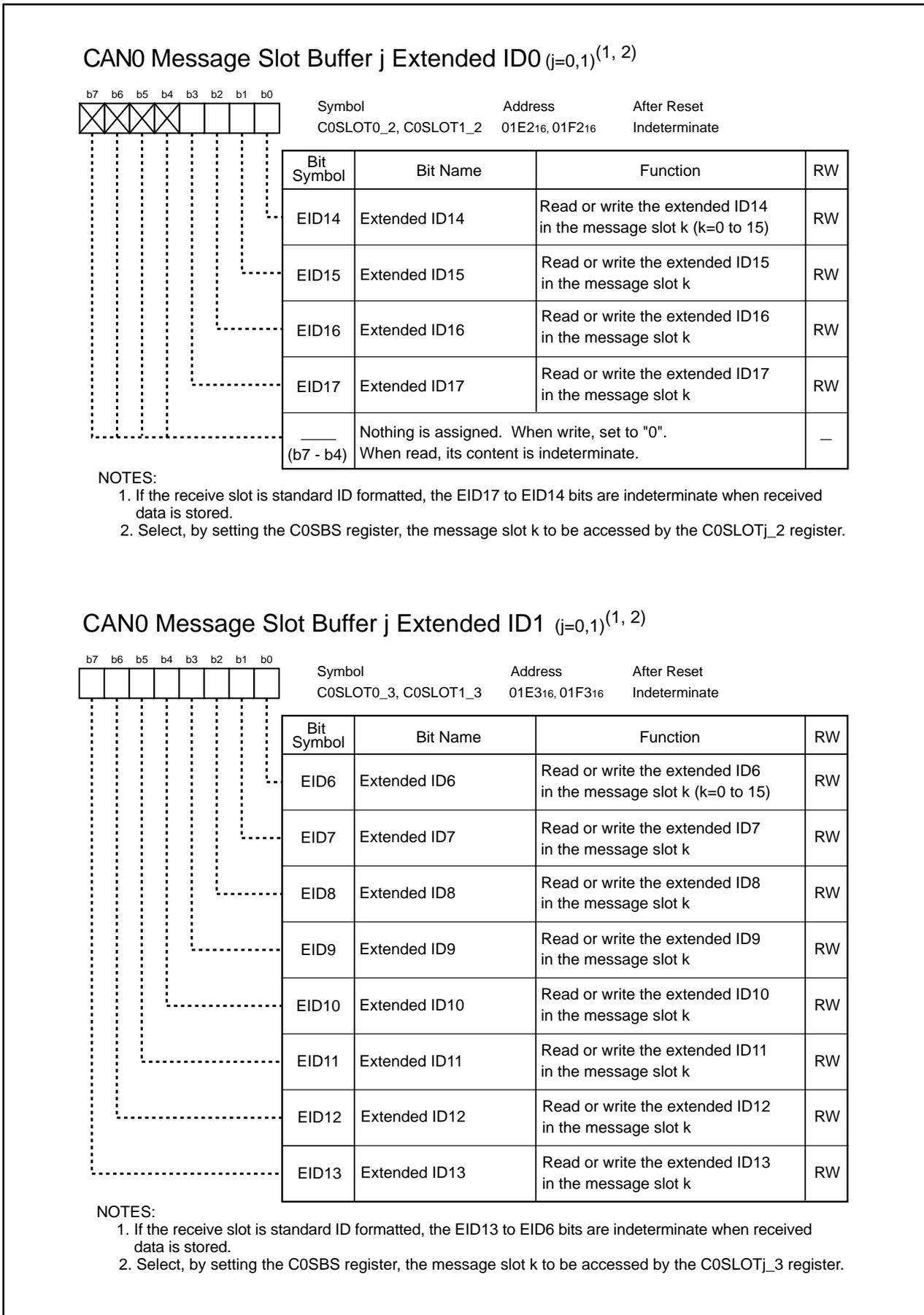
**Figure 23.32 C0SLOT0\_2, C0SLOT1\_2, C0SLOT0\_3 and C0SLOT1\_3 Registers**
